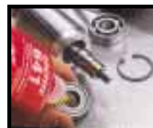
Loctite® 641 Empfohlen für zylindrische Teile die kontinuierlich gewartet und ggf. demontiert werden müssen wie z.B. Befestigung von Lagern auf Wellen oder in Lagergehäusen.
