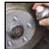
Loctite® 8150 Dose Loctite® 8151 Sprühdose Loctite® 8060 Stift Anti-Seize auf Aluminium Basis für Schrauben, Muttern, Rohre, Wärmetauscher, etc.. Typische Anwendungsbereiche: Radnaben.
